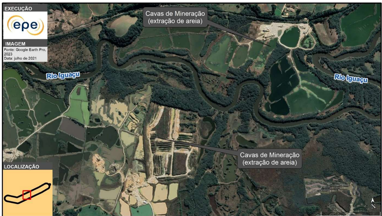
Figura 18 -Mineração às margens do rio Iguaçu, com presença de áreas alagadas, extração de areia e disposição de resíduos
